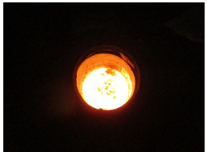
Dissolução do NbC-Fe por adição sobre o banho após a fusão da carga metálica.
