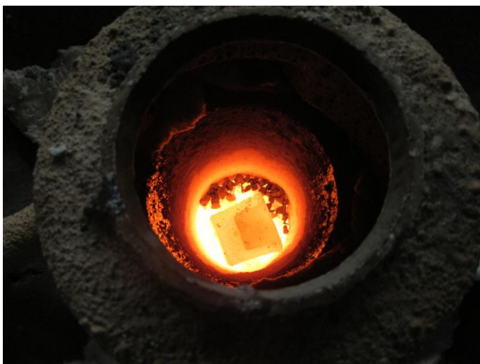
Dissolução do NbC-Fe durante a fusão da carga metálica no forno de indução.
